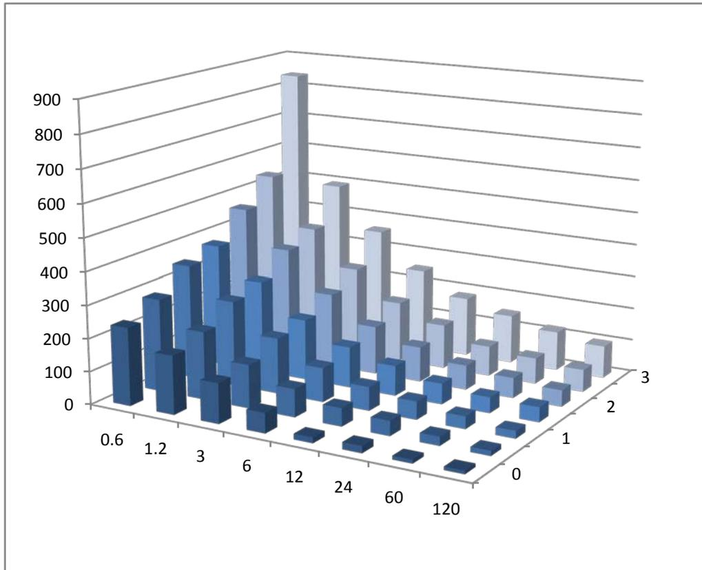
表 1 中的数据也可以用此图表示之：DNP 表观黏度 (z 坐标【竖向】，单位  $\text{mpa} \cdot \text{s}$ )，切变率 (x 坐标【横向】，单位  $\text{s}^{-1}$ )、氯化钠浓度 (y 坐标【直向】，单位  $\text{mole/L}$ )
